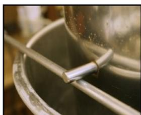
Das Ausheben des Malzrohrs beim *Braumeister* ist umständlich: bei 50 Litern braucht es zwei Personen zum Ausheben und eine dritte, die den Bügel einschiebt, auf dem das Malzrohr zum Abtropfen aufgesetzt wird. Bei den anderen Geräten wird das Malzrohr beim Ausheben um ein paar Grad gedreht und liegt dann auf einem stabilen, eingebauten Rahmen auf. Wird es beim *Braumeister* nur etwas gedreht, plumpst das Rohr wieder in die Würze - alles schon passiert!
